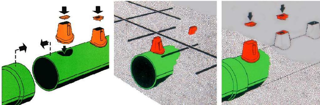
1. Die Einlaufftüllen einsetzen und mit anhängendem Klappdeckel verschließen.
