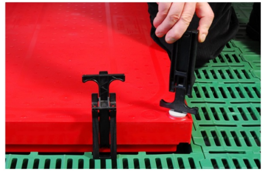
6. Verschluss mit Befüllhebeln schließen
